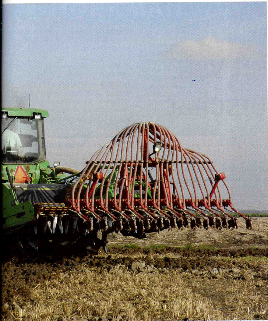
Vorig jaar draaiden de eerste twee Rotar 300-spitmachines met een Alpego-rotorkoep en zaaimachine succesvol op zware, natte grond.
