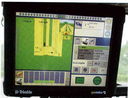
Op het scherm is zowel de trekker- als de machinebesturing te bedienen. Werkbanen overslaan geeft de grootste tijdswinst.
