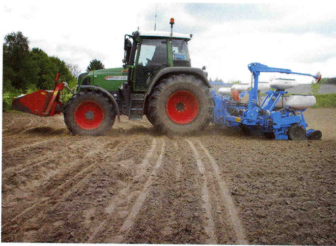
De hypermoderne zaaimachine combineert trekker en machinebesturing met sectieafsluiting en plaats specifiek zaaien.
