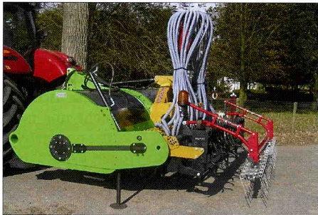
Spatenmaschine und Kreiselegge kombiniert im Modell Rotar.
