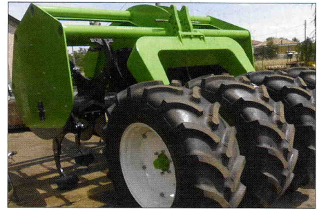
Spatentiefe bis 130 cm: Bigrotar in 3 m Breite und gezogener Ausführung.
