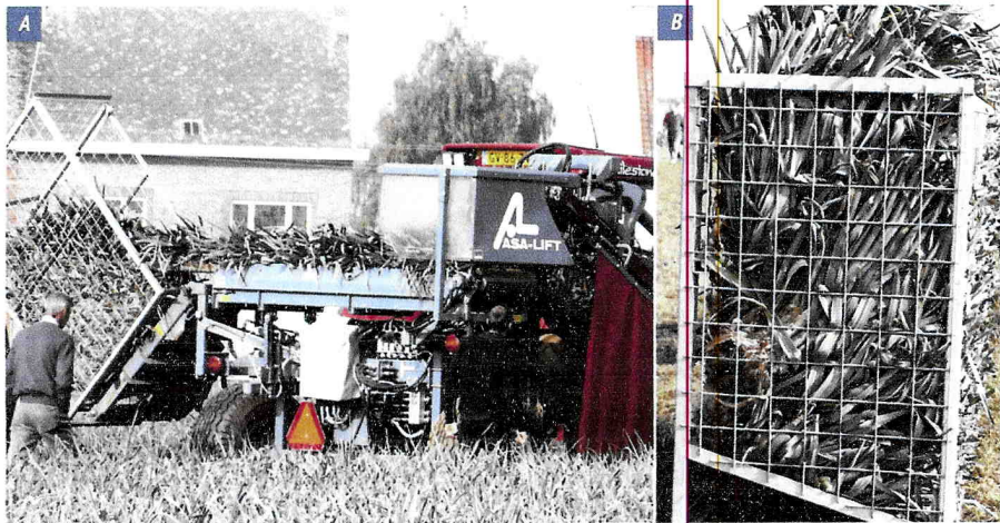
Foto 3. - De Deense fabrikant Asa-lift (importeur Farmstore) demonstreerde voor de eerste keer op de Werktuigendagen. Verschillende afmetingen van containers kunnen elektronisch worden ingegeven, voor de rest gebeurt alles automatisch. De chauffeur moet enkel de tractor op de rij houden en de diepteregeling instellen, het vullen van de container kan hij volgen met een kleine camera op de tractor. Bij deze machine wordt de container gekanteld gevuld door een uitschuifbare transportband (A). Dat resulteert in een iets onregelmatigere stapeling (B) waardoor de containers volgens de constructeur manueel moeten worden leeggemaakt. De koppen van de machine zijn gesloten, dat voorkomt verstopping op percelen met veel onkruid.
