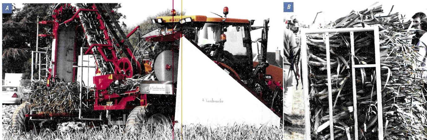
Foto 2. - De preirooier van Vanhoucke Machinebouw draait al enkele edities succesvol mee en wordt nog steeds verder verfijnd (A). Een belangrijke troef voor loonwerkers is dat er verschillende maten van containers kunnen worden gebruikt. Daarnaast wordt door de heen-en-weer bewegende arm die de prei heel lichtjes aandrukt, een perfecte horizontale stapeling bekomen in de container (B), het blad wordt in de praktijk wel korter afgesneden dan tijdens deze demonstratie.
