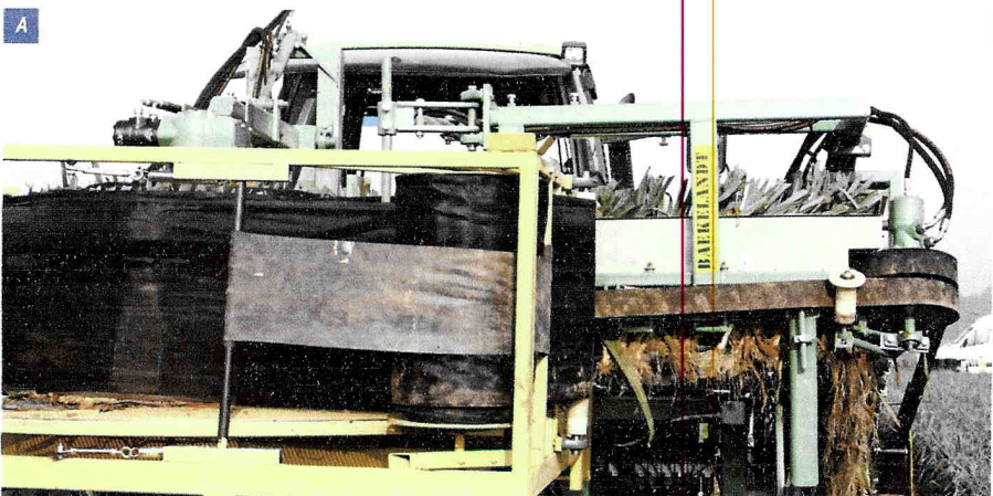
Foto 5. - De firma Baeckelandt Metaalconstructie demonstreerde naast zijn traditionele automatische preirooier met de standaardcontainer ook zijn nieuwste telg met het oprolsysteem in matten (A). Deze nieuwe rooier aangepast aan dit oprollende mechanisme is nog volop in ontwikkeling. Met het gedemonstreerde prototype heeft men nog maar 3.000 kg prei geoogst, vanaf januari hoopt men volledig klaar te zijn. Naast de container is ook de rooier zelf grondig veranderd en vooral veel lichter geworden. De containers rollen de prei verticaal op tussen de matten (B). De containers hebben een vierkant kader en kunnen worden gestapeld.
