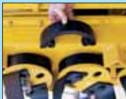
SEMIPROTEZIONI ROTORI (RC-RD) • SEMI PROTECTION OF THE ROTORS (RC-RD) • SCHÜTZUNG FÜR DEN ROTOREN (RC-RD)
