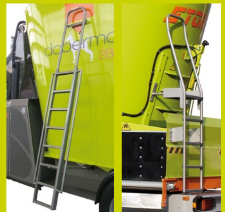
Echelle d'inspection Inspectietrap
