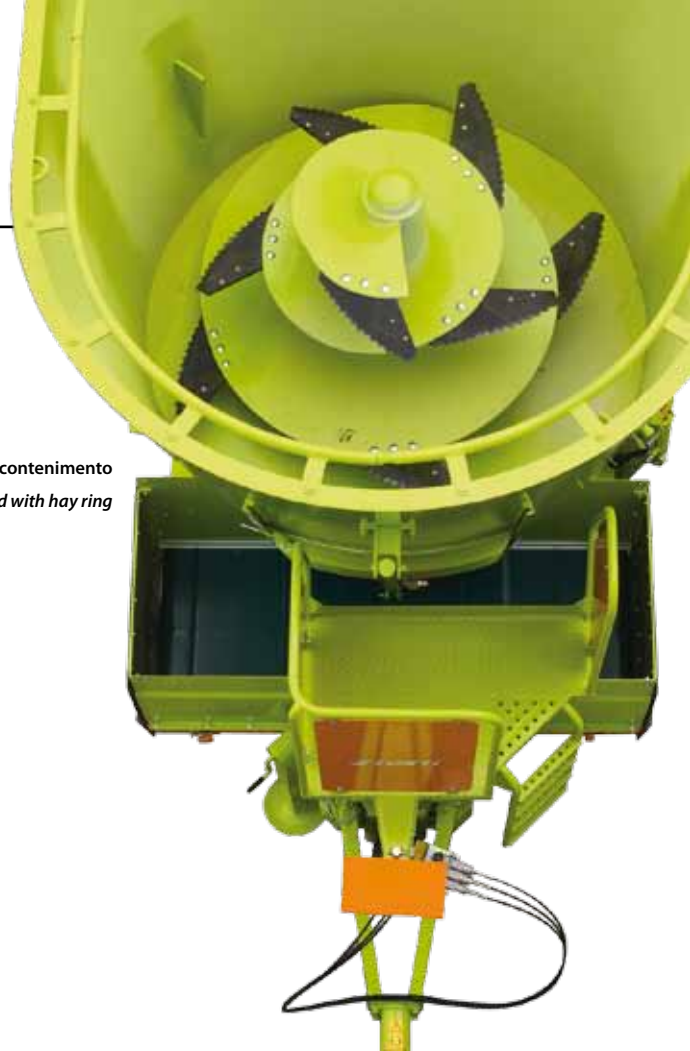
Coltelli standard (disponibili con o senza rivestimento al tungsteno)
