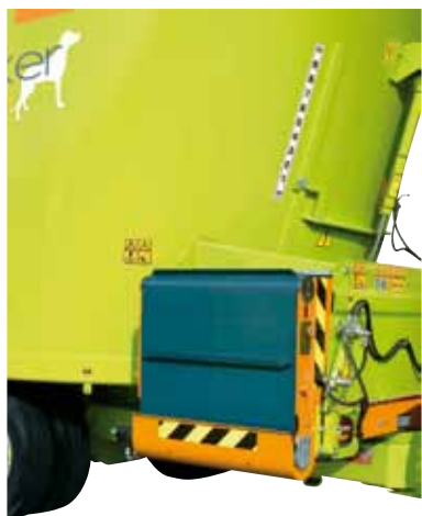
TVs | TV2 Prolunga di scarico G6,5 a comando idraulico
