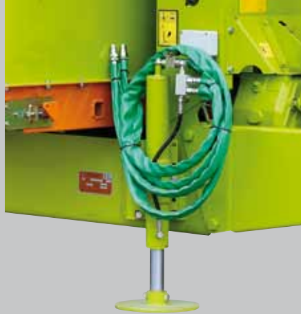
Piede di appoggio a comando oleodinamico collegato all'impianto idraulico del trattore Hydraulic foot connected to tractor hydraulics and controls
