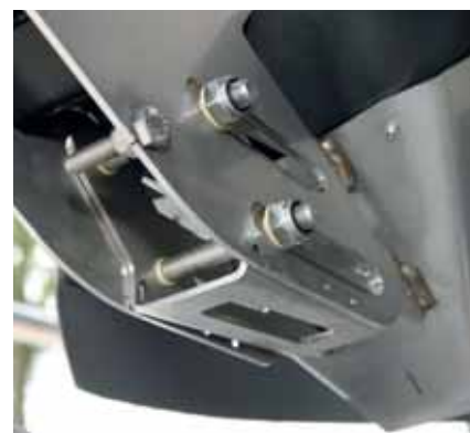
Via een verstelbaar rvs-tuitje valt de kunstmest op de schoep en zijn werkbreedte en de kantstrooi-instelling in te stellen.
