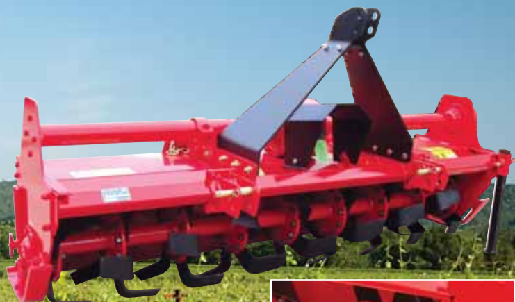
Transmisión lateral por cadena Entraînement latéral par chaîne Chain-type transmission
