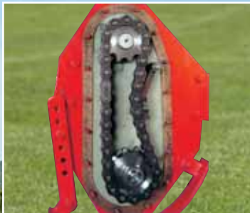
Transmisión lateral por cadena Entraînement latéral par chaîne Chain-type transmission
