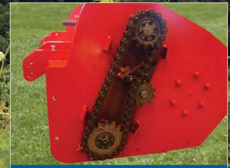
Transmisión del pick-up por cadena Entraînement du pick-up par chaîne Drive transmitted to pick-up by oversized chain and pinions
