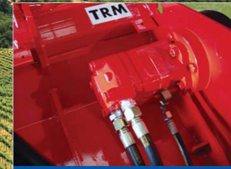
Motor hidráulico para pick-up (opcional) Moteur hydraulique pour entraînement du pick-up (optionnel) Hydraulic motor for pick-up (optional)
