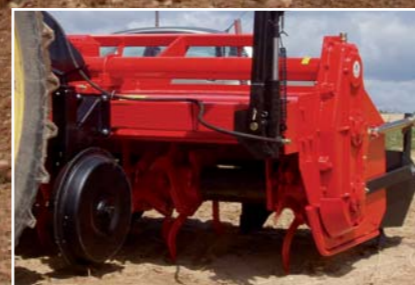
Eje rotor con bridas desmontables Rotor à bridas démontables Rotor with removable clamps
