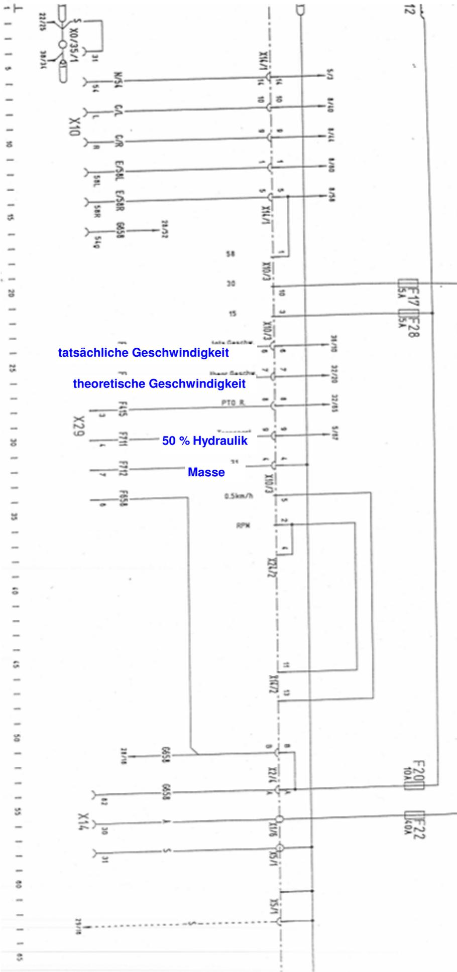
Print hinter Handbremshebel (Nähe EHR Box) Steyr 9094, CS 110
