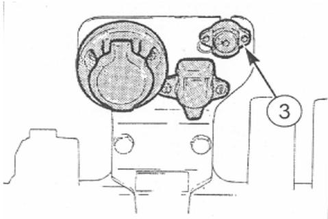
Die Signalsteckdose dient zur Übertragung von Signalen für Bordcomputer, Hektarzähler und Gerätesteuerung (Spritzen etc.) und ist nur möglich in Verbindung mit Digitaltraktormeter.
