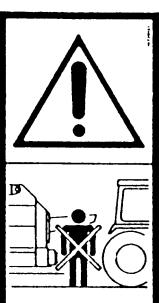
⑩ **DANGER:** ne pas stationner entre la machine et le tracteur pendant le fonctionnement.
