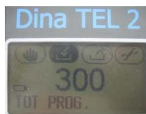
Während der Aufführung ist es möglich das Wiegen zu blockieren, drückend die Taste BLOCK
