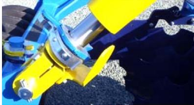
Capuchon de la tige de piston commandant les rouleaux et des rondelles d'espacement contre les pierres partant d'au près des disques arrière
