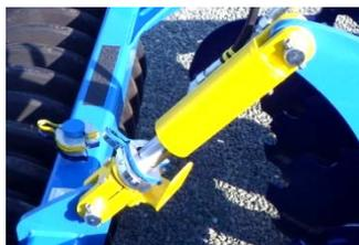
Commande hydraulique pour les machines Softer 4,5 NS et Softer 6 NS
