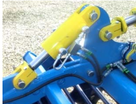
Commande hydraulique de l'essieu pour les machines Softer 4,5 PS et Softer 6 PS
