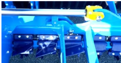
Protection du tige de piston contre les pierres partant
