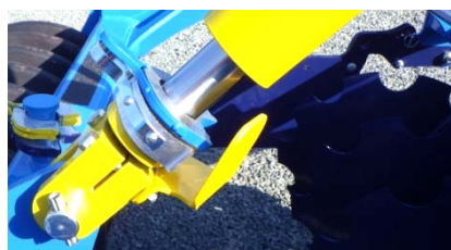
Capuchon de la tige de piston commandant les rouleaux et des rondelles d'espacement contre les pierres partant d'au près des disques arrières
