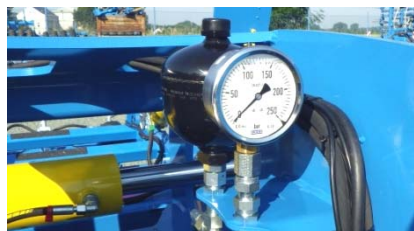
Adaptation automatique au relief du terrain et pression constante des châssis latéraux dans le cas des machines Softer 8 PS et Softer 11 PS grâce au récipient d'accumulation d'équilibrage
