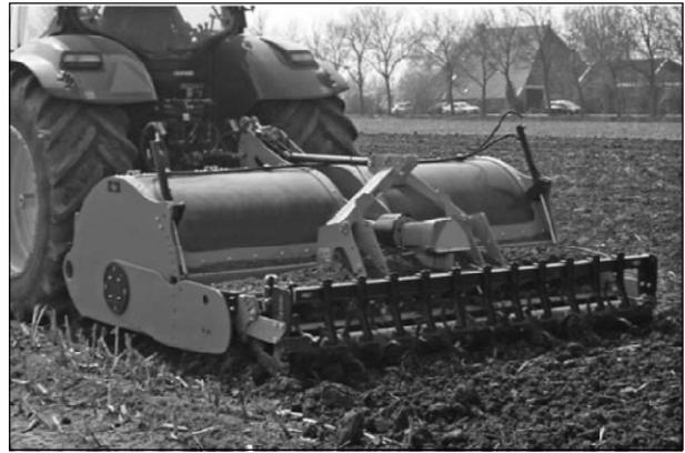
Fig. 5 - Rotoaratro-Ripuntatore in lavoro con erpice rotante
