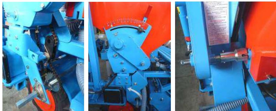
► Entraînement sur châssis TFC par variateur (Trémie 1500 litres)
