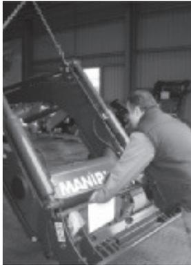
*Pousser à la main le chargeur et engager les potences du chargeur sur l'adaptation du tracteur.*
