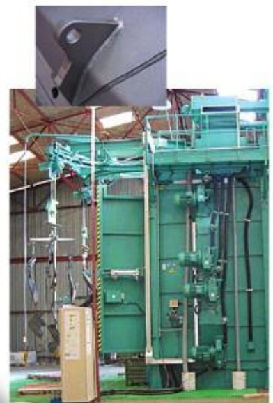
Grenailage des pièces chargeurs et outils avant peinture.
