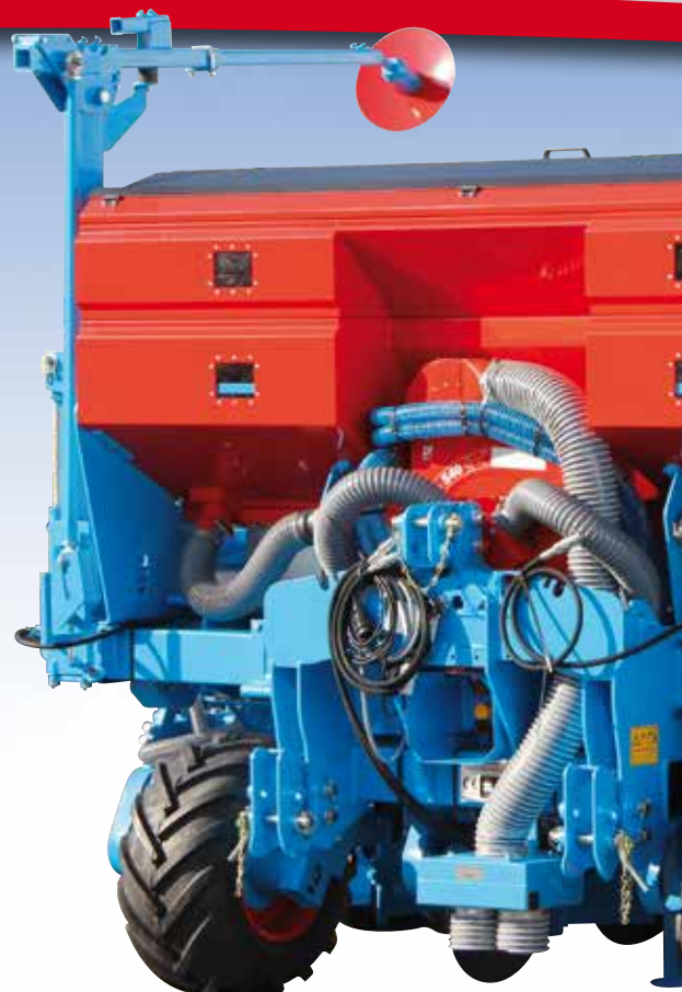
Zaaimachine met 6 rij Monoblock2 Comfort frame met kunstmest 1030 liter en gecombineerde Microsem (rij-afstand 75 cm)
