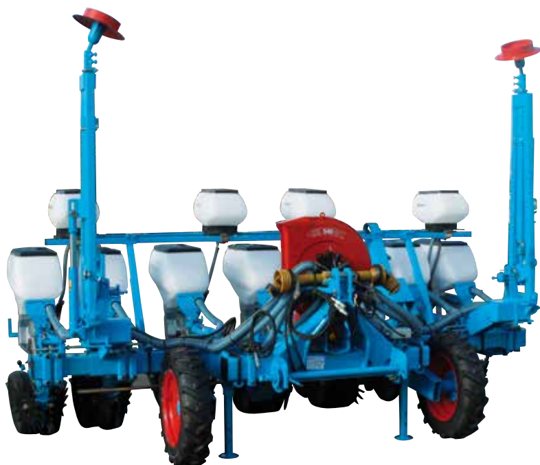
Zaaimachine met wielen voor de hoofdbalk voor kleinere rijafstanden of zaaien in steenachtige grond.
