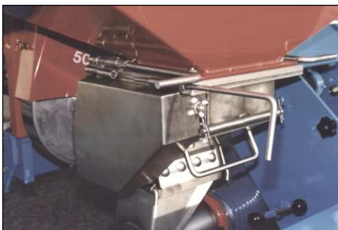
Démontage du boîtier de distribution après verrouillage des deux trappes. Disassembly of distribution unit after closing the two trap door. Abbau des Verteilungsgehäuses nach der Verriegelung der beiden Klappen. Smontaggio della scatola di distribuzione dopo chiusura delle due saracinesche.
