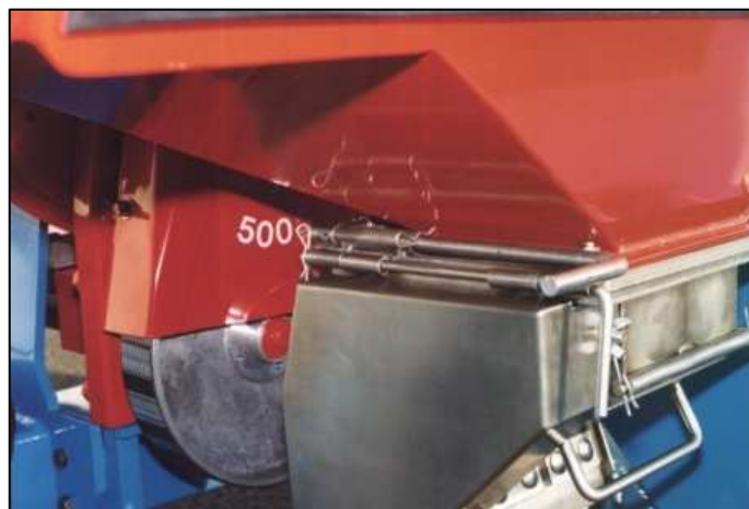
Fermeture et verrouillage d'une trappe Closing and bolting of a trap door Verschluß und Verriegelung einer Klappe Chiusura e Chiusura con catenaccio di una saracinesche
