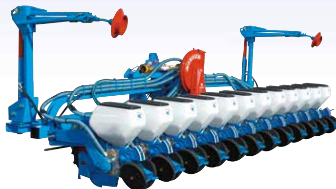
NC Technic Mais zaaimachine 12-rij dubbele balk opklapbaar frame (45 cm)
