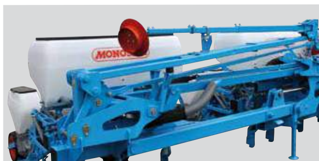
NC Technic Mais zaaimachine 12-rij dubbele balk opklapbaar frame (45 cm)
