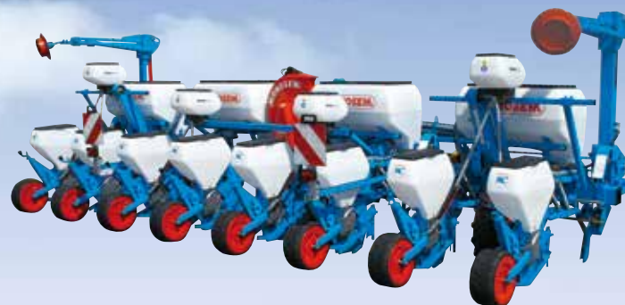
NC Classic V2 zaaimachine 8 rij dubbele balk opklapbaar frame (75 cm) Microsem en kunstmest 4 x 175L met meskouters
