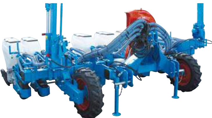
Zaaimachine met wielen voor de hoofdbalk voor kleinere rijafstanden of zaaien in steenachtige grond.
