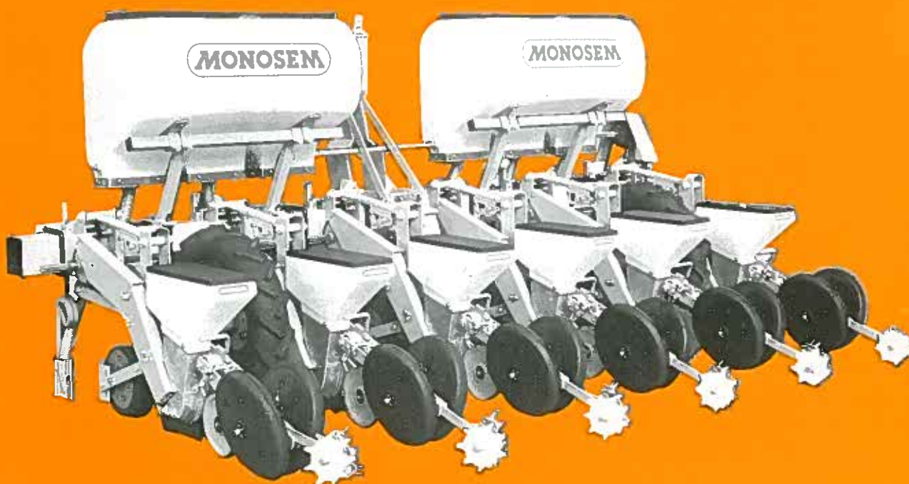
MECA 2000 avec fertiliseur et option roto herses
