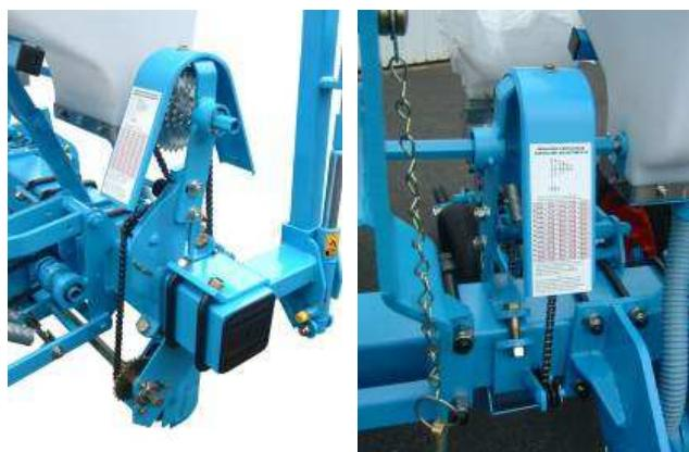
► Entraînement sur châssis Monobloc (Trémie plastique & 980 litres), et châssis Monobloc 2 avec trémie 1020 litres.
