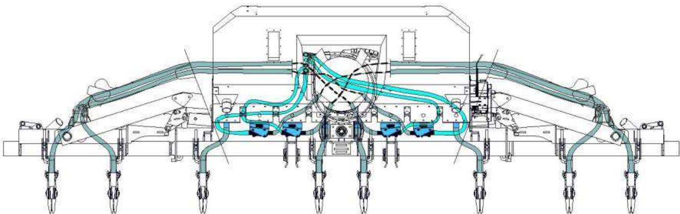
Le transport de l'engrais sur les 4 rangs extérieurs jusqu'aux enfouisseurs est pneumatique sur châssis TFC et Monobloc 2. Livré en standard avec trémie fertiliseur 1500 litres pour châssis TFC et 680+350 litres pour châssis Monobloc 2.
