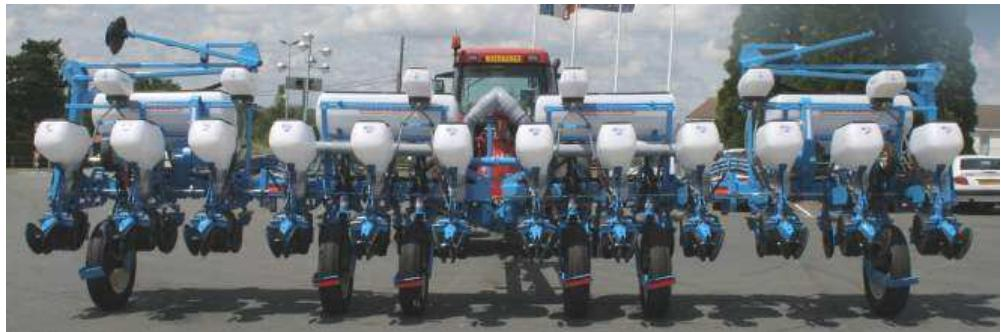
► Trémies « grande capacité » (semoirs 6 rangs : Monobloc 260 / Monocloc 2 / Extend)
