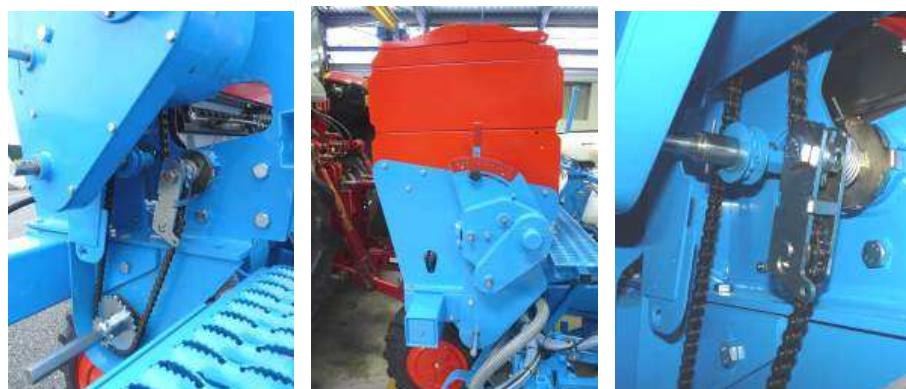
► Entraînement sur châssis trainé WingFold 8 rangs repliable par variateur (Trémie 1500 litres)
