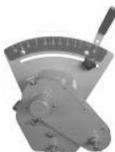
**⚠** Plusieurs paramètres peuvent faire varier les débits (granulométrie, hygrométrie, ...). Ils sont à vérifier obligatoirement sur le terrain par un essai préalable afin de pouvoir rectifier le réglage, si nécessaire, pour obtenir réellement la dose/hectare désirée.
