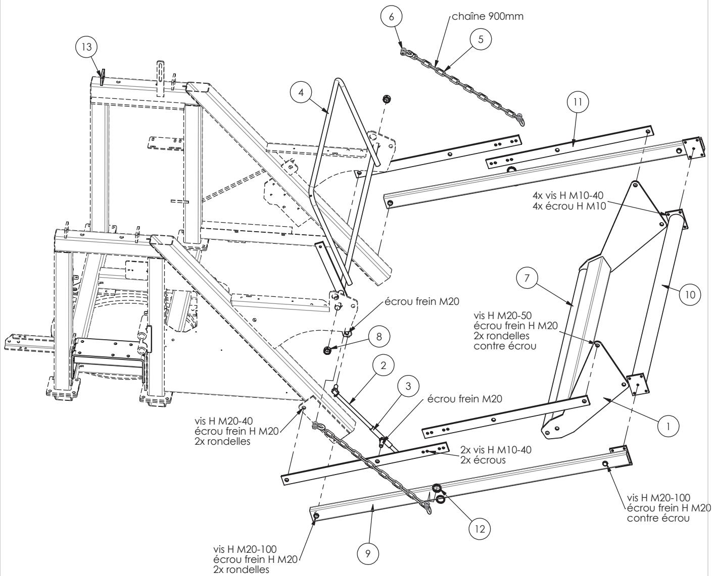
Kit modification pour le passage d'un relevage automatique au relevage hydraulique : 54KITSAV0003
