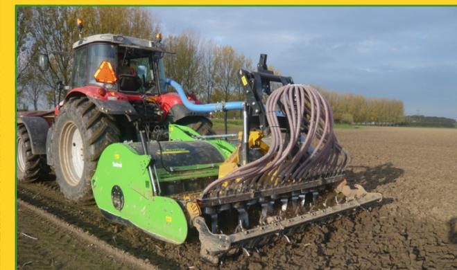
Mit der ROTAR Spatenmaschine kann man in Verbindung mit der Alpego Kreiselegge in einem Arbeitsgang ausgezeichnet graben und säen. Großer Vorteil hierbei ist das der Boden nicht zusätzlich befahren wird und Spurbildung verhütet.
