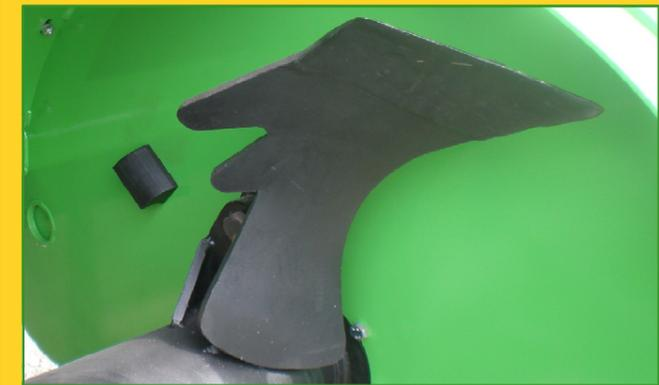
Die Farmtec ROTAR Spatenmaschine ist spezifisch für den schweren Boden entwickelt worden. Durch die Rister-Form wird der Boden ausgebrochen und gekehrt und die Bodenstruktur und der Wasserhaushalt verbessert.
