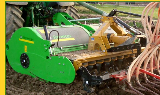
Die ROTAR Spatenmaschine ist mit Mittenantrieb (keine Ketten in der Maschine!) und durchgehender Zapfwelle versehen. Die Alpego Kreiselegge kann hiermit integral in die Maschine montiert werden.
