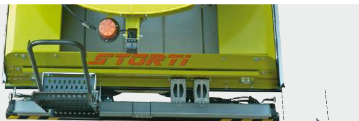
Querförderband mit Seitenverschiebung bis zu 30 cm Déport latéral tapis qui se déplace jusqu'à 30 cm Verschuifbare band die zich verplaatst tot op 30 cm
