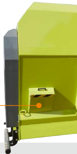
Mineralentrichter in der Wannenseite Entonnoir pour concentrés sur le caisson standard Standaard krachtvoertrechter op de tank
