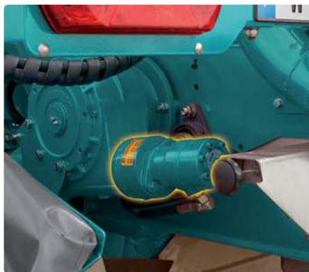
Hydraulische aandrijving van band om tank snel leeg te kunnen draaien aan het einde van de werkzaamheden (optioneel)
