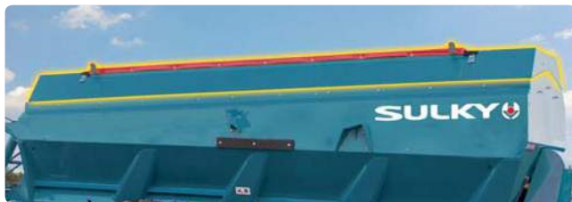
Tankdank met centrale opening voorzien van een zeil (optioneel)
