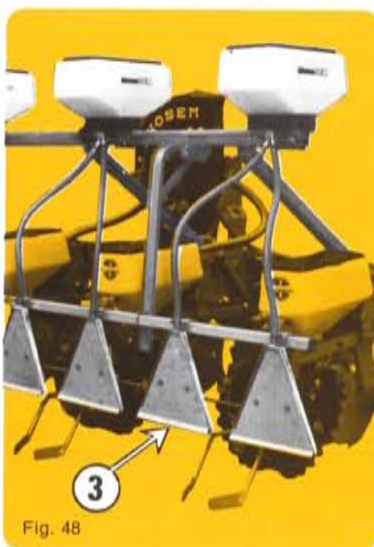
Fig. 48 : rampe herbicide généralisée Fig. 49 : rampe herbicide localisée Fig. 50 : rampe anti-limaces (guide descente) Fig. 51 : entraînement pour les 3 modèles
