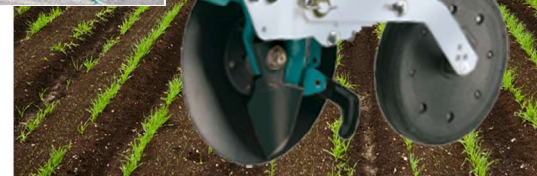
Uit te voeren met na-eg met rechte tanden of slepende tanden en aandrukwielen voor een beter contact tussen zaad en bodem.
