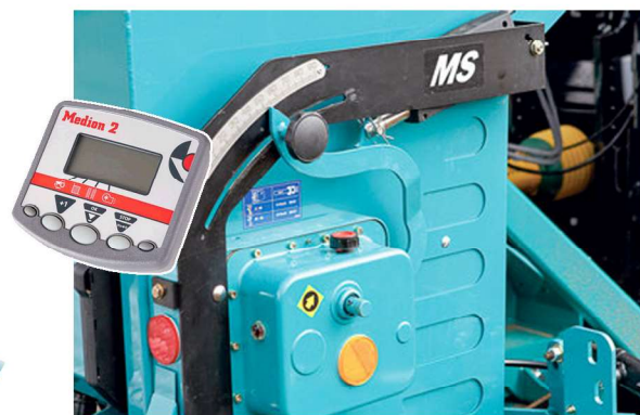
Variator met grote schaal voor nauwkeurige instelling. Elektrische regeling als optie.
