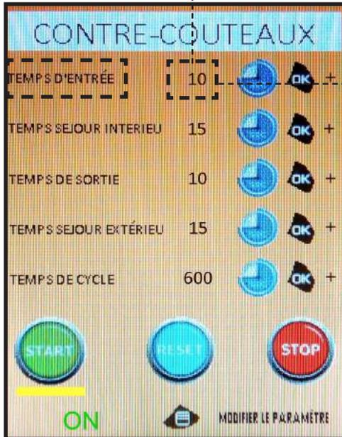
**TEMPS D'ENTRÉE** : il s'agit des secondes de configuration du travail de l'électrovanne; celles-ci peuvent être modifiées en enfonçant le bouton OK pour augmenter ou diminuer (MAXIMUM 60 secondes programmables).
