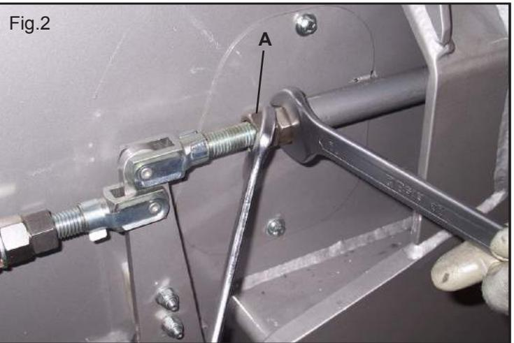
Une fois l'écrou desserré **A** (fig.2), serrer l'écrou **B** (fig.3) en le tournant de 1 à 3 tours **maximum** (il est conseillé de procéder par grades) et vérifier en cours d'œuvre.
