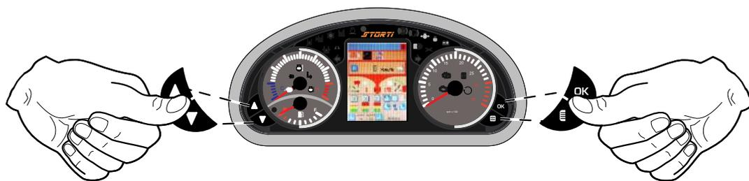
Pour entrer dans le menu "reset", sélectionner la première page de l'écran, puis enfoncer simultanément les 4 boutons pendant environ 10 secondes ; la page où saisir le mot de passe pour entrer, s'affiche. (mot de passe 0000). En appuyant sur RESET on sélectionne le chiffre puis on confirme avec OK (la sélection et la confirmation sont à faire pour chaque chiffre du mot de passe) en maintenant enfoncé OK du dernier chiffre pendant quelques secondes.
