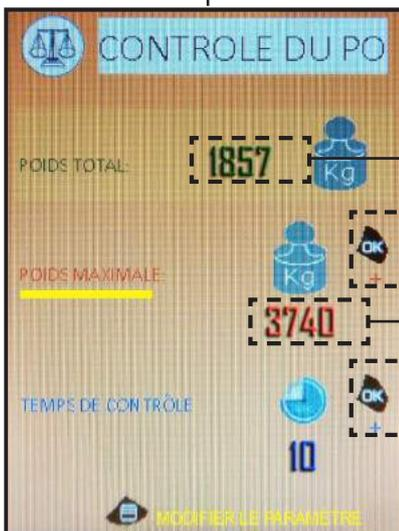
POIDS TOTAL : on voit, en temps réel, le poids du produit qui est chargé dans le caisson
