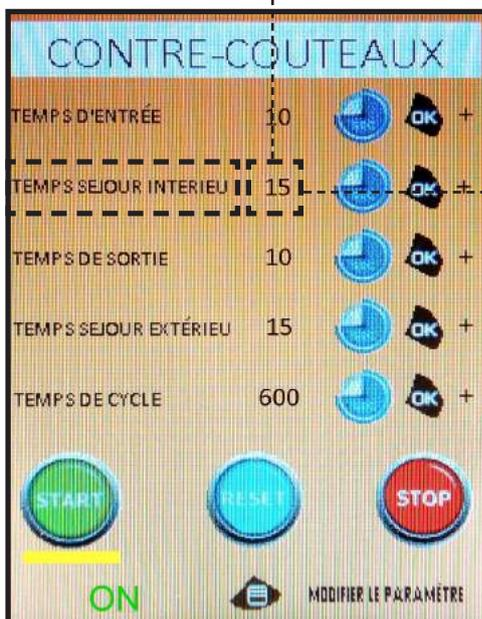
**TEMPS D'ARRÊT DEDANS** : il s'agit des secondes d'insertion de la contre-lame à l'intérieur de la cuve ; la durée de l'arrêt à l'intérieur du caisson peut être modifiée en agissant sur le bouton OK pour augmenter ou diminuer le temps (MAXIMUM 1800 secondes programmables).
