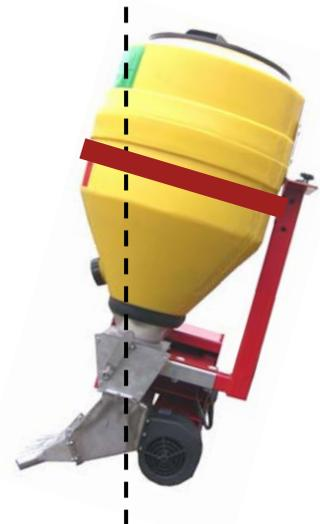
Zusätzliche Halterung notwendig, damit der Behälter nicht ausreißt. Je nach Neigung kann ein Rest Saatgut im Behälter liegen bleiben. Die Streubreite verringert sich, je schräger der Öko-Air montiert wird.
