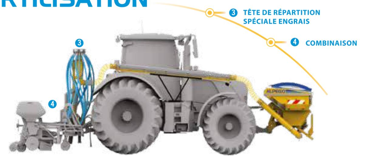
En configuration engrais, avec une tête de répartition spéciale, permet à la trémie d'équiper différentes machines : bineuses, semoirs monograine, déchaumeurs, préparateurs, rouleaux, etc...
