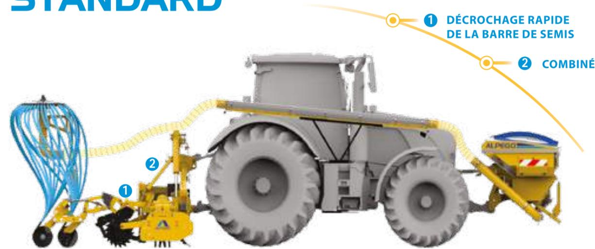
La configuration standard comprend la trémie frontale, les barres de semis, la **tête de répartition centralisée sur la barre** avec le jalonnage et les herse arrière de recouvrement.
