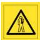
Toutes les pièces extérieures du circuit hydraulique peuvent s'échauffer pendant le service. Prendre les précautions nécessaires pour éviter les brûlures. La température de l'huile hydraulique ne doit pas excéder 80°C.
