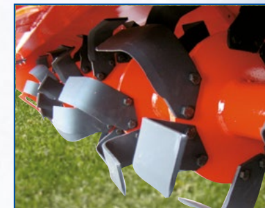
Rotorwelle mit "08-L" Messern Rotoras met messen "08-L"
