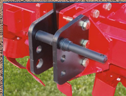
Kupplungsplatten Platen met bouten / aa nkoppeling voor herframen
