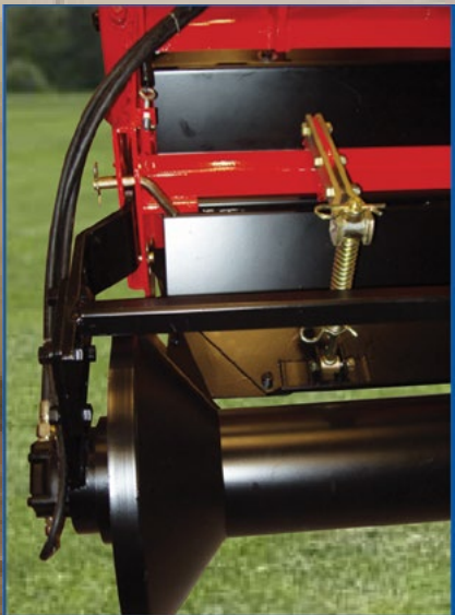
Verschiebbarer Kegel (Diabolo) Instelbare conische rol
