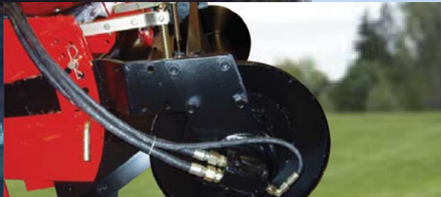
Hydraulischer Motor Hydraulische aandrijving kantschijf
