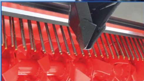
Dammformer und hinterer Steinkamm Spijlenrooster voor scheiden grond
