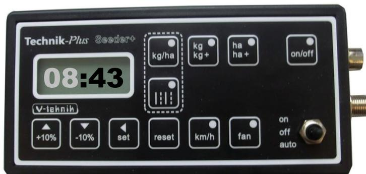
**Startsequenz** = Tritt unmittelbar nachdem die SEEDER+ Steuerung mit der Batterie verbunden wird auf. Am Display wird eine strichlierte Linie angezeigt und die LEDs an den Tasten beginnen nacheinander zu leuchten.
