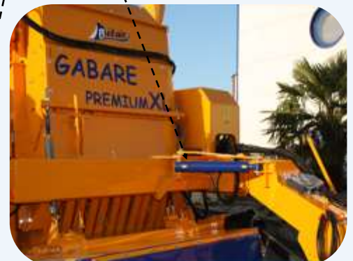
Hydraulische disselverstelling met transportvergrendeling
