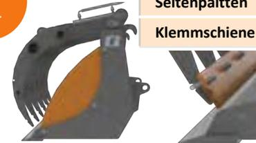
HINWEIS! Für den Einsatz des Geräts mit harten Gegenständen wie Baumstämmen und Baumstümpfen, muss die Klemmschiene verwendet werden, um Beschädigungen an den Greifer-Zinken zu vermeiden.
