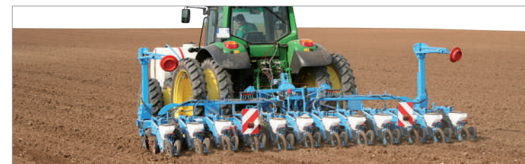
12-rijige zaaimachine MECA V4 met opklapbaar frame met dubbele balk
