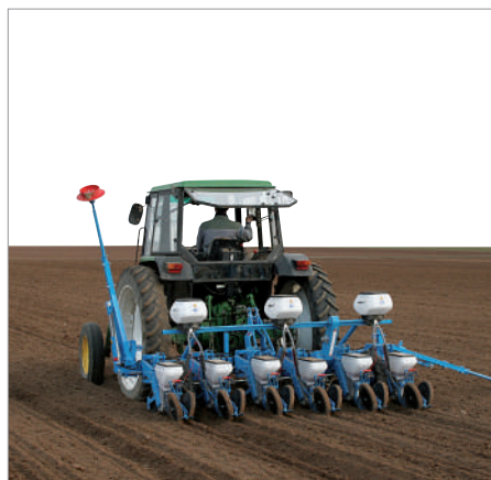
6-rijige zaaimachine MECA V4 met star frame met enkele balk en Microsem
