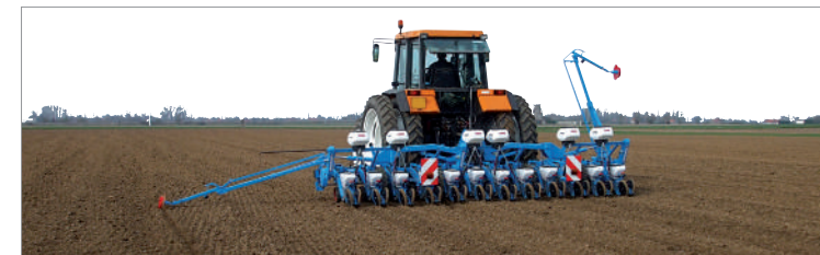
12-rijige zaaimachine MECA V4 met compact opklapbaar frame en Microsem
