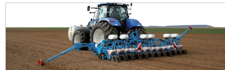
12-rijige zaaimachine MECA V4 met opklapbaar frame met dubbele balk en Microsem
