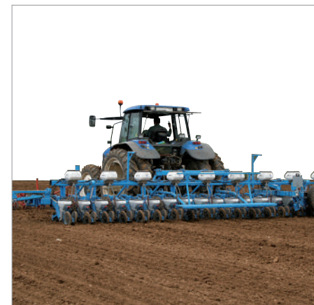
18-rijige zaaimachine MECA V4 met star frame met drievoudige balk, Microsem en transportwagen
