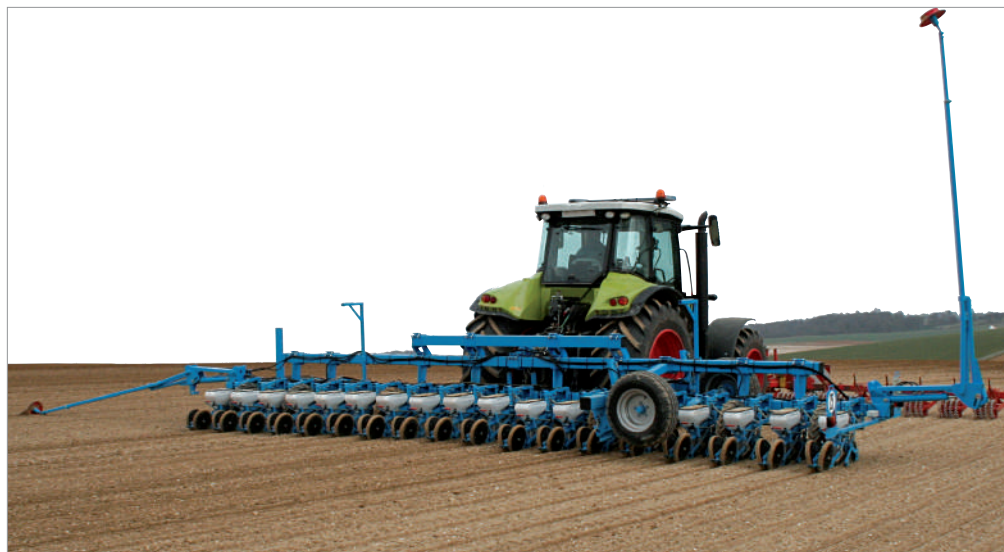
18-rijige zaaimachine MECA V4 met star frame met drievoudige balk en transportwagen
