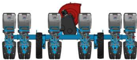
3,5 m 6-rijige zaaimachine met telescopisch frame tijdens transport
