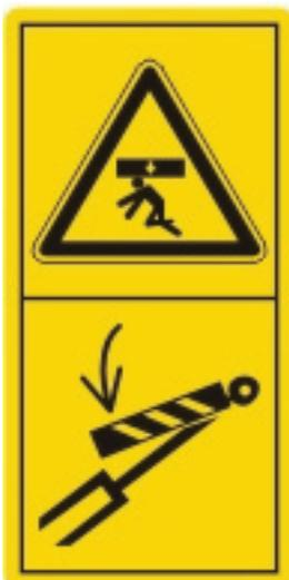
Nicht im Schwenkbereich klappbarer Maschinenteile aufhalten!
